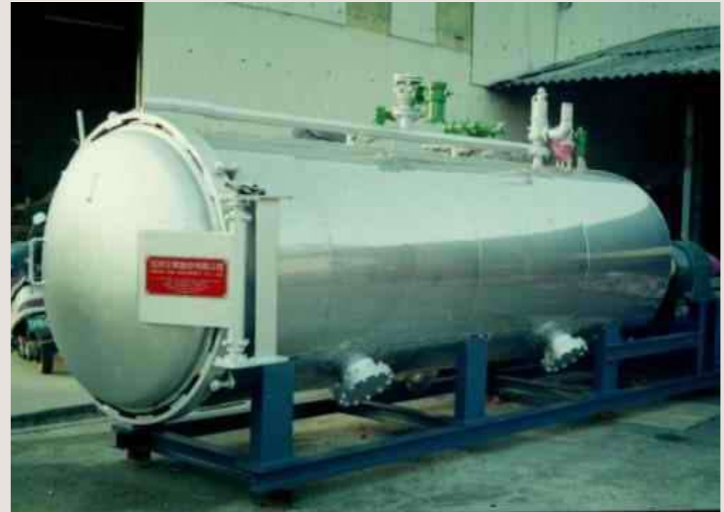
Sterilizācijas iekārta, izmantojot tvaiku*
