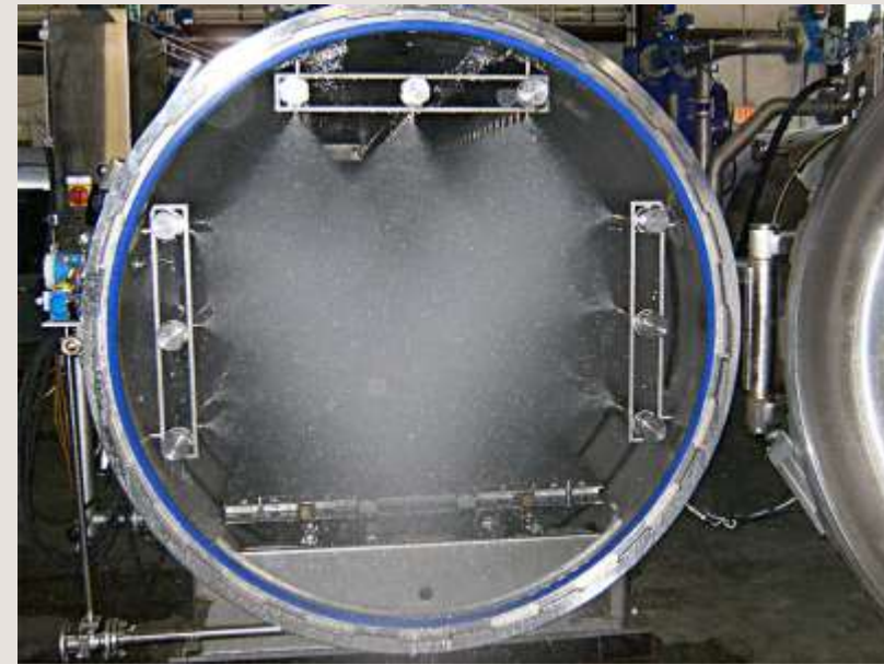
Ūdens smidzināšanas sterilizācijas iekārta**
